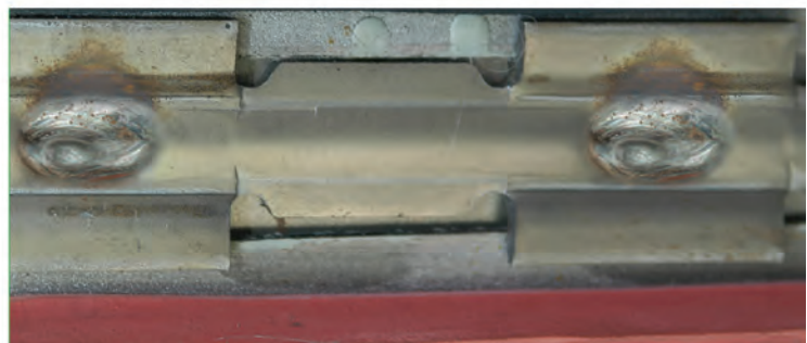
Glissière double: Tous les trous oblongs doivent être soudés
