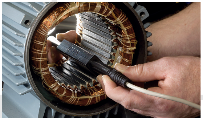
Détection de défauts du stator d'un moteur AC avec l'aide d'une sonde de test se déplaçant de segment en segment du stator.
