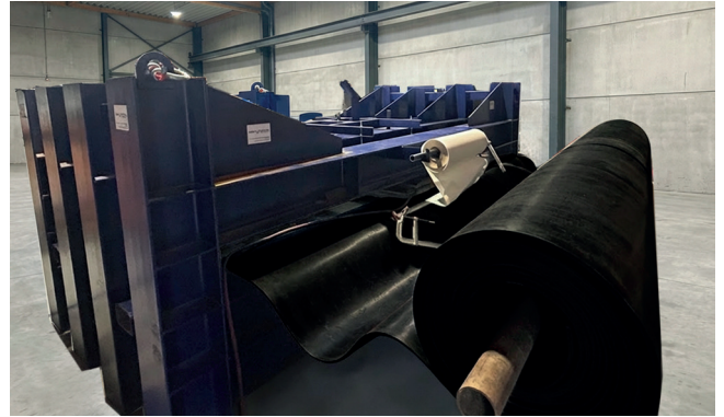
Notre structure de vulcanisation grande largeur.
