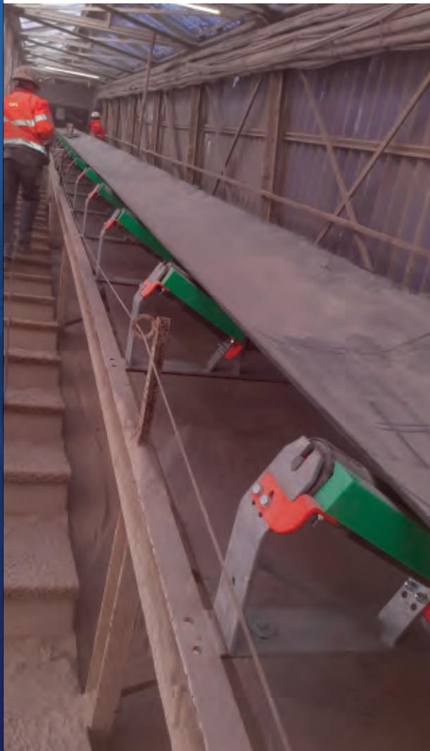
**Optim'Protec® est une gamme de protections rapprochées d'angles rentrants. Ces protections rapprochées permettent de mettre en conformité avec la norme 2006/42/CE les transporteurs à bande sans avoir recours à des protections contraignantes pour l'exploitation et la maintenance (enceinte fermée à accès contrôlé, protections grillagées). Cette conformité est obligatoire pour le constructeur mais aussi pour l'utilisateur solidairement responsable en cas de manquement.**
