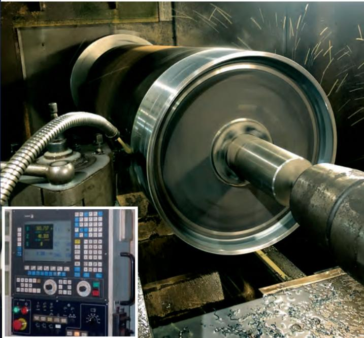
Usinage des structures du tambours avec nos machines numériques
