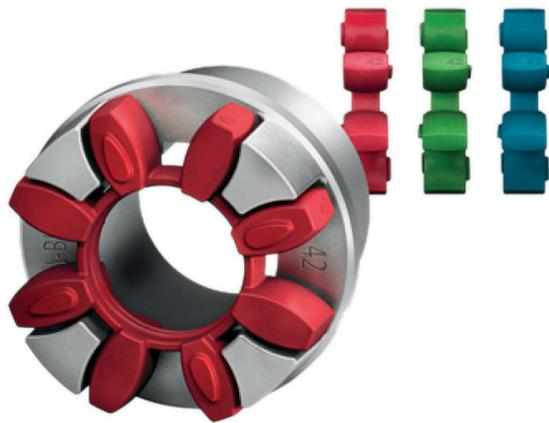
Les gammes traditionnelles proposent des accouplements comparables avec un couple maximal de l'ordre de deux fois le couple nominal de l'accouplement. **Si l'on souhaite**, par exemple, **jouer la sécurité lors du démarrage d'un moteur** asynchrone avec leur couple de démarrage et couple de décrochage typiques, il faut souvent recourir à une taille supérieure. Pour des vitesses élevées ou des alésages relativement grands, **le marché propose souvent des solutions en acier coûteuses.**
