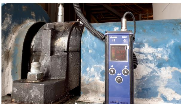
Graissage par vibrations ou ultrason
