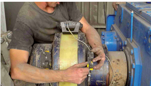
Laseruitlijning van een industriële tandwielkast
