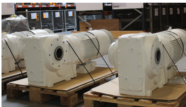
Reparatie van motorreductoren
