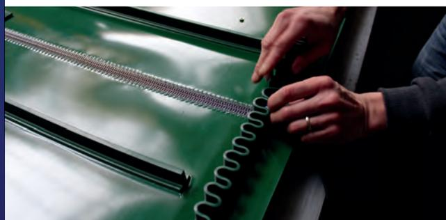
*Placement et jonctionnement de bandes PVC-PU*
